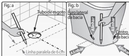
Coloque a bacia na posição de instalação, alinhando o furo lateral da bacia com o traço do piso. Alinhe também o centro da bacia (frontal) com o traço do piso (Fig. b). Trace no piso o contorno externo da base da bacia. Retire a bacia. Vire a bacia, posicione os suportes L' (7) alinhando o centro do furo lateral da bacia com o centro do furo do suporte L' (7). Com uma trena ou metro meça a distância A (Fig. c). Trace no piso a distância A marcando o local para furação (Fig. d).
